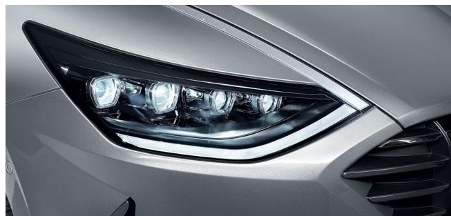
Светодиодные фары проекционного типа
