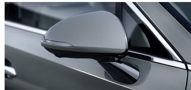
Электропривод складывания зеркал
