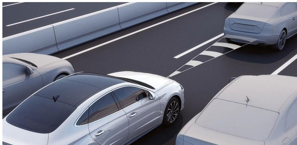
Система автоматического торможения перед препятствием спереди (FCA)
