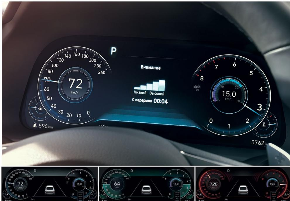
Цифровая приборная панель с HD-дисплеем 12,3 дюйма / Выбор режима движения (Comfort / Smart / Eco / Sport)
